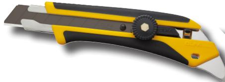
Está fabricada para para tareas súper pesadas, con su hoja de **18 mm** y sus guías que están fabricadas de acero de alta resistencia. Posee un seguro circular con sistema ratchet que previene que la hoja se retraiga al aplicar una gran fuerza al momento de cortar.
