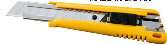
La cuchilla **EXL** está fabricada para para tareas pesadas, utiliza una hoja de 18mm, fabricada de acero - carbón. Posee un seguro tipo ratchet, que provee una mayor fuerza de sujeción de la hoja y que no permite que la hoja se retraiga al momento de aplicar una gran fuerza al momento de cortar.
